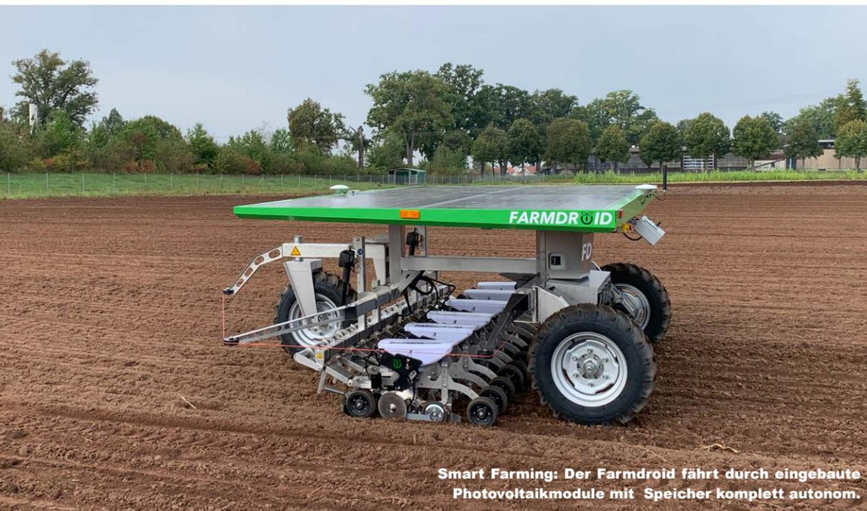
Smart Farming: Der Farmdroid fährt durch eingebaute Photovoltaikmodule mit Speicher komplett autonom.
